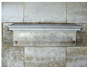
Slika 7.12 Meter – palica za merjenje dolžine. Prikazan je javni etalon, izdelan na podlagi meritev poldnevniškega loka skozi Francijo. Etalon je vzidan v pročelje hiše v Parizu. (Anon)
