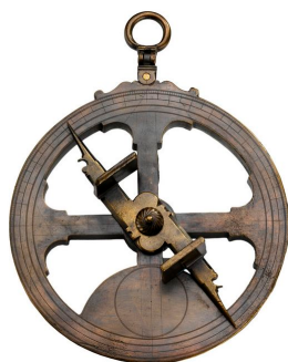
Slika 6.1 Astrolab – viseči krog z namerilno palico za merjenje višine nebesnih teles nad obzorjem. Prikazana je replika instrumenta, ki je služil španskim jadrnicam pri prvih čezoceanskih plovbah. (National Maritime Museum, Greenwich)
