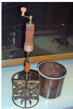
Slika 22.3 Mešalec za mehanično segrevanje vode, ki ga je uporabljal J. Joule. (Science Museum, London)
