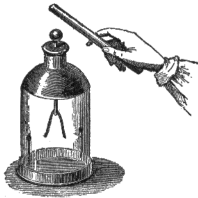
Slika 24.3 Elektroskop z zlatima lističema. Če sta lističa naelektrena, to je, če vsebujeta višek ali primanjkljaj elektronov, se odbijata. (Hawkins, 1914)
