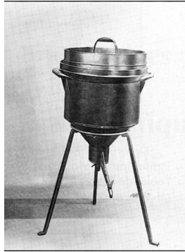
Slika 22.6 Kalorimeter – merilnik toplote. Prikazan je prvi kalorimeter na led, ki ga je uporabljal A. Lavoisier. (Musee des Arts et Metiers, Pariz)
