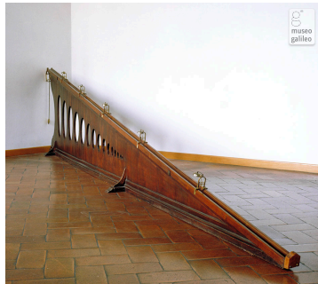
Slika 18.2 Replika klanca za spuščanje kroglic, ki ga je uporabljal G. Galilei. Tako se upočasni prosti pad. Kroglice spotoma cingljajo na zvončke. Če so ti postavljeni na primernih razdaljah, je cingljanje po posluhu enakomerno. (Museo Galileo, Firenze)
