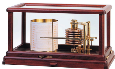
Slika 10.7 Aneroidni barograf. Izsesani kovinski meh se širi in krči pod vplivom zunanega zračnega tlaka. Te spremembe se prenašajo na vzvod, ki piše po vrtečem se valju. (Anon)
