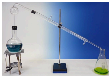
Slika 11.5 Pribor za destilacijo. Hlajenje vročih plinov v izhodni cevi poteka z vodnim protitokom od spodaj navzgor. (Anon)
