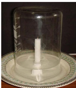
Slika 11.2 Gorenje sveče pod steklenim zvonom. Ta je postavljen v mlako vode, da je boljše zatesnjen. Sveča ne gori do konca, marveč predčasno ugasne. Pri gorenju se spreminja sestava zraka. Skupna teža vseh snovi v zvonu se pri tem ne spremeni. (Anon)
