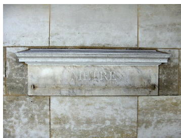
Slika 8.12 Meter – palica za merjenje dolžine. Prikazan je javni etalon, izdelan na podlagi meritev poldnevniškega loka skozi Francijo. Etalon je vzidan v pročelje hiše v Parizu. (Anon)
