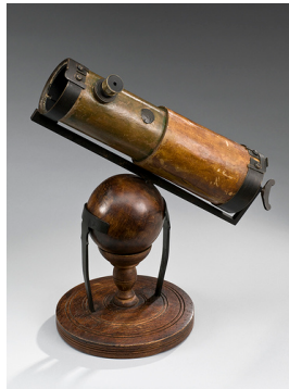
Slika 12.13 Daljnogled za gledanje oddaljenih predmetov. Prikazana je replika prvega zrcalnega daljnogleda, ki ga je lastnoročno izdelal I. Newton. Namesto zbiralne leče na začetku cevi uporablja zbiralno zrcalo na njenem koncu. Svetloba se odbija naprej, kjer jo majhno poševno zrcalo usmeri v stran v okular. (Science Museum, London)
