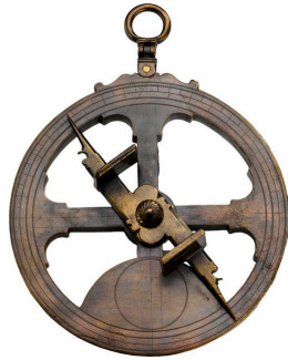
Slika 7.1 Astrolab – viseči krog z namerilno palico za merjenje višine nebesnih teles nad obzorjem. Prikazana je replika instrumenta, ki je služil španskim jadrnicam pri prvih čezoceanskih plovbah. (National Maritime Museum, Greenwich)
