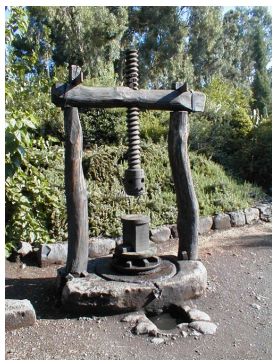
Slika 9.8 Vijačna stiskalnica za stiskanje oliv. V luknjo na vijaku vstavimo dolgo ročico. Pod vijakom namestimo posodo z olivami. (Anon)
