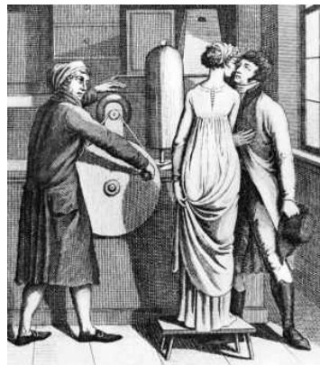
Slika 24.4 Drgnjenje roke ob vrtečo se stekleno ploščo ustvarja pozitivne naboje na plošči in negativne v roki. Prvi se prenašajo in kopičijo na kovinskem valju, drugi sproti odtekajo v Zemljo. Ko se izolirana gospodična dotakne valja, se tudi sama naelektri pozitivno. Poljub gospoda ustvari prevodno povezavo z Zemljo, po kateri steče naboj ob "prijetnem" ščemenju. (Bose, 1744)
