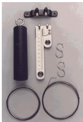
Slika 20.1 Pribor za merjenje raztega žice. Z leve sponke, pripete na strop, visi pomožna žica z glavno skalo na spodnjem koncu; napeta je s pomožno utežjo. Z desne sponke visi merjena žica s kazalcem v obliki nonijske skale. Deset nonijskih enot ustreza devetim enotam na glavni skali. Merjeno žico obremenimo z različnimi utežmi. Nonij drsi ob glavni skali in omogoča meritve z natančnostjo 0,1 mm. (Global Lab Ware)
