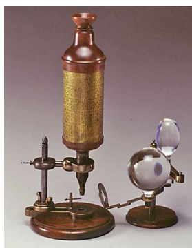
Slika 12.11 Replika mikroskopa za gledanje drobnih predmetov, ki ga je uporabljal R. Hooke. Opazovani predmet je osvetljevan s svečo skozi zbiralno stekleno kroglo. (Science Museum, London)
