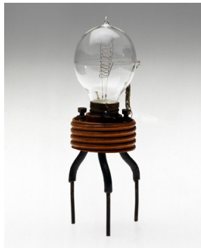
Slika 40.1 Dioda. Dioda je vakuumna cev z dvema elektrodama: vročo katodo (žarilno nitko) in hladno anodo. Prikazana je prva uporabna dioda, ki jo je sestavil J. Fleming. (Science Museum, London).
